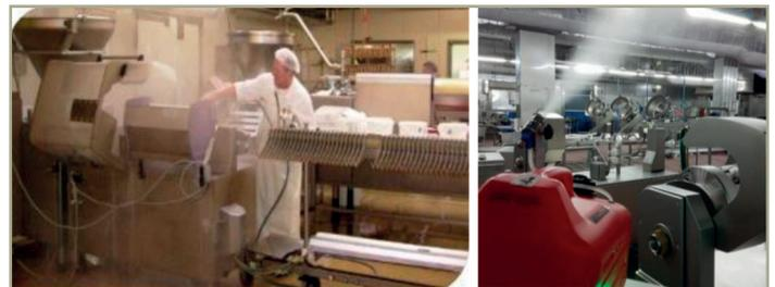
▲ Einsatz der Zweistoffdüsenteknik als mobile Einheit Deckeldüse in der Füllerei.
